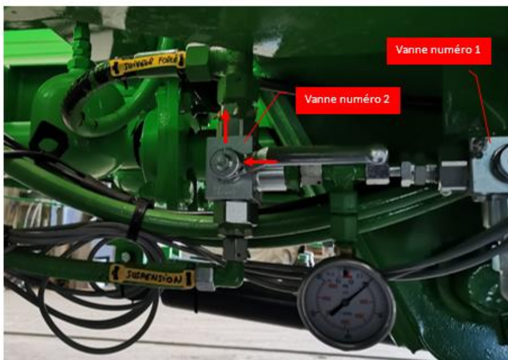
Figure 4 Vanne numéro 2 en position suiveur forcé
