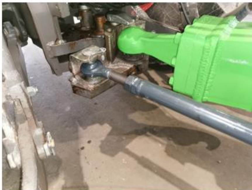
Figure 9 Barre de liaison reliée au tracteur
