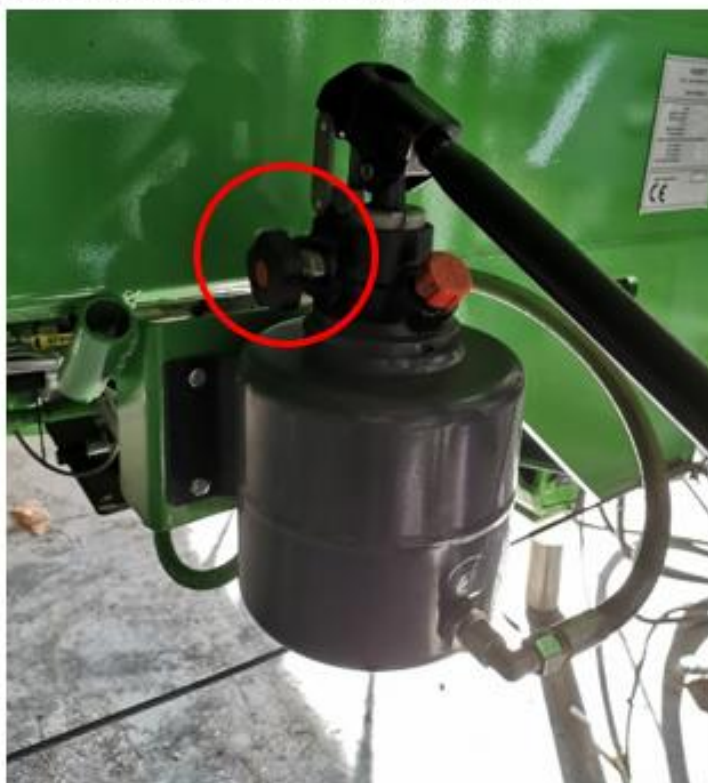
Figure 6 Robinet de la pompe à main
