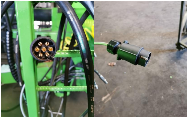
Figure 1 Prise 7 plots mâle située sur le front poussant
